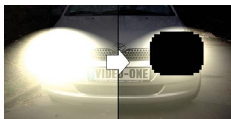
Wird der Sichtbereich der Kamera von Lichtquellen geblendet, werden diese Teile automatisch verdeckt, damit andere Teile nicht überblendet werden. Dies ist zum Beispiel hilfreich bei der Identifizierung von Kfz-Kennzeichen.
