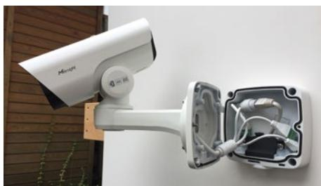
Die Anschlusskabel werden durch die im Wandarm integrierte Anschlussbox innerhalb der Kamera aufgelegt. So benötigen Sie keine externe Verteilerdose, um die Kabel im Außenbereich sicher zu verbinden.
